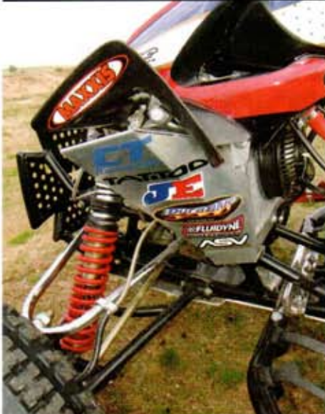
Σκούπες αέρα. Μαζή με το τεράστιο ψυγείο υπόσχονται σταθερή θερμοκρασία παντού
