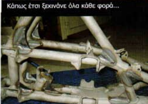
Όταν ενυσχύεις ένα σασί για να επιτρέπεται να τρέξει στο GNNC πρέπει ακόμη και οι ενυσχύσεις να έχουν συγκεκριμένο μέγεθος και σε συγκεκριμένο μέρος. Δεν μπορείς να κάνεις ότι θέλεις.
