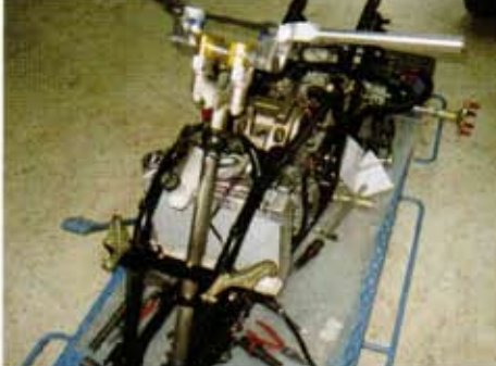
Η κολόνα τιμονιού είναι LAEGER's με αντικραδασμικές βάσεις. Ενώ το τιμόνι αντικραδασμικό και αυτό απο την QUAD SPORT. Φοβερός συνδιασμός. Δεν περνάει στα χέρια τίποτα!
